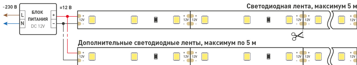
Схема 1. Подключение нескольких светодиодных лент с одной стороны.
